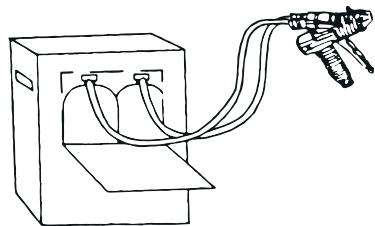
3. Empuje la parte superior del panel trasero para abrir. Tire hacia abajo de la solapa del conjunto de manguera de la unidad dispensadora. Retire el paquete de boquillas y lea las instrucciones.
