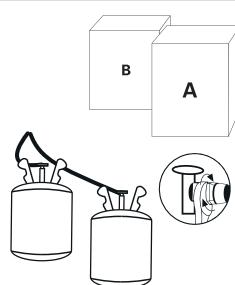
3. Enrosque **LA MANGUERA CODIFICADA EN ROJO AL CILINDRO DEL COMPONENTE A Y LA MANGUERA CODIFICADA CILINDRO DE COMPONENTE B** y apriete con la llave de 9/16 "incluida.
