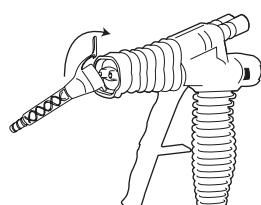
2. Inserte la pestaña inferior de la boquilla en la ranura inferior de la unidad dispensadora.
