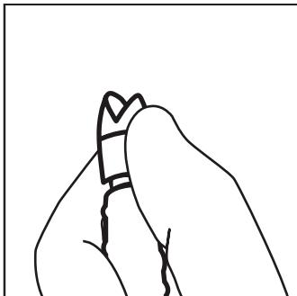
2. ¡Quite fácilmente la punta del ventilador para cambiar el patrón de rociado!
