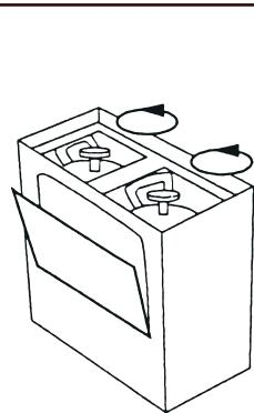
4. Abra la tapa superior de la caja para exponer las válvulas del cilindro. Extienda el conjunto de manguera de la unidad dispensadora adjunta.
