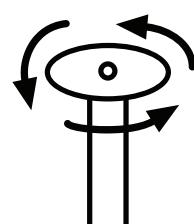
4. Abra las válvulas por completo girando las válvulas EN SENTIDO CONTRARIO A LAS HORAS DEL RELOJ. Las válvulas del cilindro deben estar erguido durante el uso.
